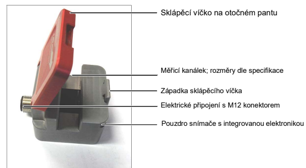
Obr 1: Konstrukce snímače SONOFLOW CO.55 V2.0 s hliníkovým pouzdrům
